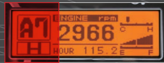
アクセル変速時の変速段数表示
