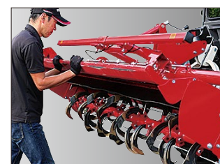
ロータリカバー「上げのみ解除」 リヤカバーを持ち上げるだけでロックがかかる「上げのみ解除機能」を装備しており、掃除が楽です。
