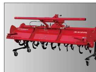
キャストースタンド ロータリの脱着や単体での移動、保管が楽に行える専用スタンドです。
