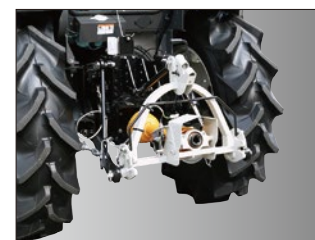
5Pスーパーヒッチ (Y仕様:GM452D・502D(ET) Q仕様:GM552D) ロータリの脱着がワンタッチで行える、5Pスーパーヒッチを採用。配線を取外す必要ありません。
