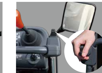
ジャストディレクタ 条合わせの左右微調整が簡単にできます。操作しやすいスティックタイプを採用。
