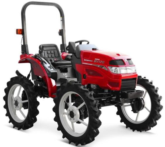
「MV170」は、生産コストの低減と軽労化、機械化が進む近年の農業、特に畑作のニーズに応える野菜作向けハイクリアランス(最低地上高420mm)乗用管理機として、低振動・低騒音を実現した排気量952ccで17馬力を発揮する三菱製ハイパワーエンジンを搭載。様々な圃場条件に合わせて、1,140mm、1,200mm、1,430mmとトレッド幅の変更を可能とし、1.2m平うね、2尺3寸うねに対応。さらに、狭い圃場でも繊細な作業をアシストする前進9段/後進3段の多段トランスミッションを採用。耕うんの深さを任意の位置で設定できる深耕自動や作業機の水平(もしくは任意の位置)に保持する水平自動機能も標準装備。
